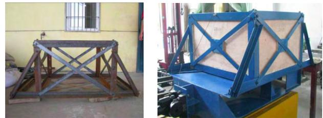
(a) 模型箱结构 (b) 模型箱体
